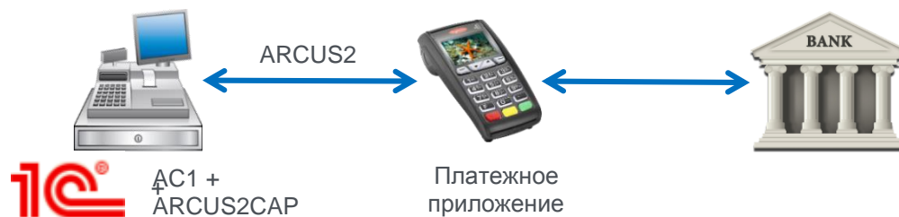
Рис. 8. Схема работы Модуля AC1
