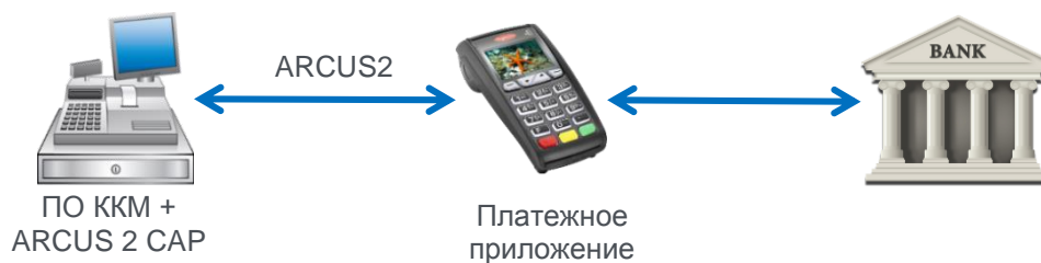
Рис. 1. Схема работы ARCUS 2 CAP
