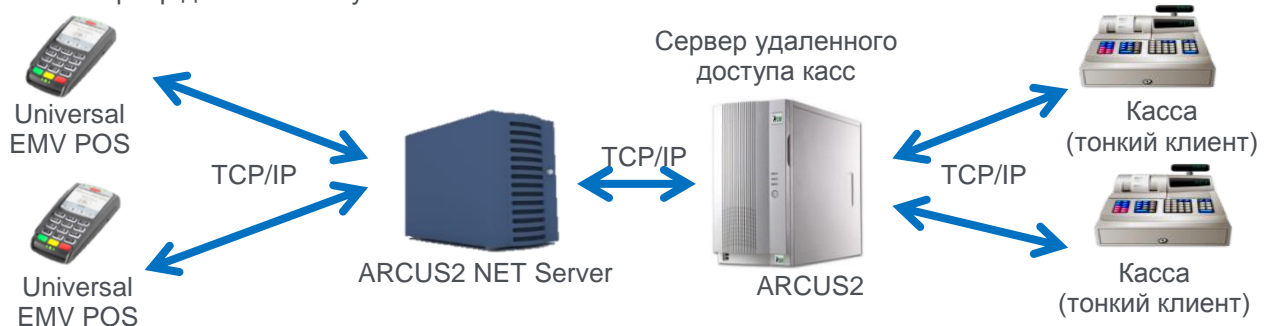
Рис. 11. Схема работы ARCUS NET Server v.1.3
